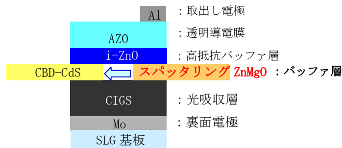
図.2 評価を行ったCIGS太陽電池のセル構成
